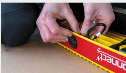
Placez fermement le capteur dans le boîtier spécial.
