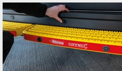
Utilisez les capuchons pour couvrir les trous où les capteurs étaient auparavant situés sur le véhicule into dans le pare-chocs arrière.
