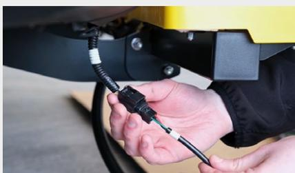
Connectez l'autre extrémité du câble Connect+ au faisceau de câbles d'origine du véhicule. Attachez solidement tous les autres câbles du véhicule.
