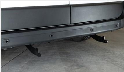
Vissez les supports de montage sur les points de montage d'origine sous le châssis. Placez ensuite la marche-pied sur les supports de montage.
