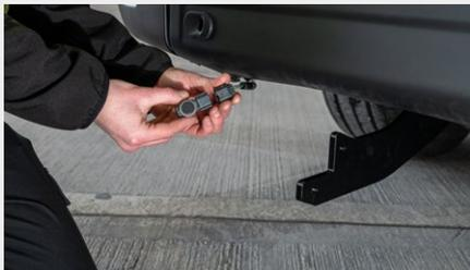
Tout d'abord, démontez les capteurs OEM du pare-chocs arrière et déconnectez-les du faisceau de câbles.
