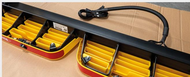
Les modifications nécessaires à l'addition d'un marchepied externe avec technologie de détection de stationnement prenaient auparavant beaucoup de temps, en exigeant souvent des connaissances spécialisées, un recâblage compliqué et, naturellement des dépenses supplémentaires. Connect+ résout facilement ce problème en intégrant chaque capteur d'origine dans le marchepied grâce à un simple câble prêt à l'emploi « plug & play ».
