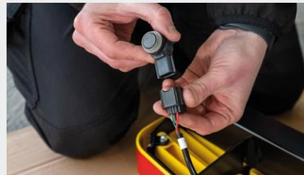
Encliquez chaque capteur dans le faisceau électrique fourni avec le marche-pied (remarque : il est représenté sans le marche-pied monté à titre indicatif).
