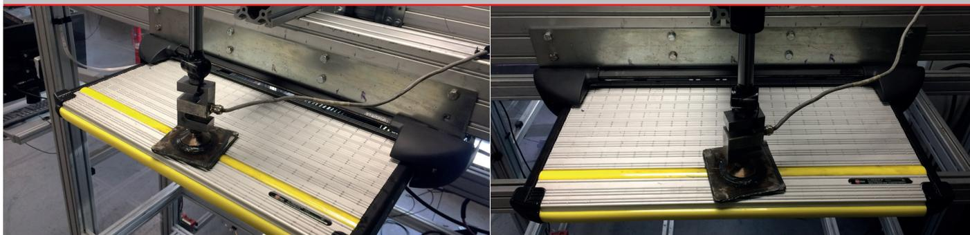
Le Glide Step a fait l'objet d'une série de tests rigoureux afin d'assurer sécurité, fiabilité et performance supérieure. Elle inclut notamment des tests de charge sur des dizaines de milliers de cycles, en augmentant les poids aux positions centrale et excentrées.
